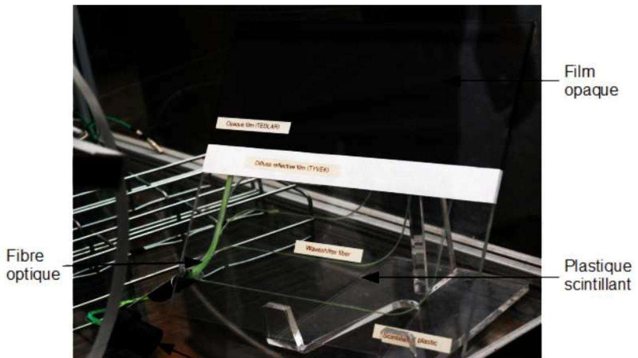
Câble de fibre optique allant vers les tubes photomultiplicateurs
